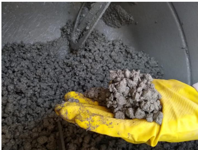
Figura 15 – Análise visual do concreto permeável.
